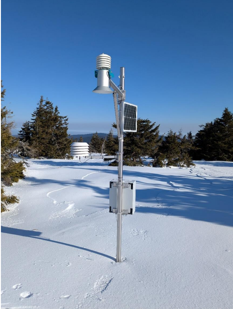
Automatická sněhoměrná stanice s měřením výšky sněhové pokrývky v lokalitě Jelení studánka (vlevo) a Malý Děd (vpravo) v Jeseníkách, leden 2026 (Jelení studánka) a únor 2025 (Malý Děd), foto: V. Šustková
