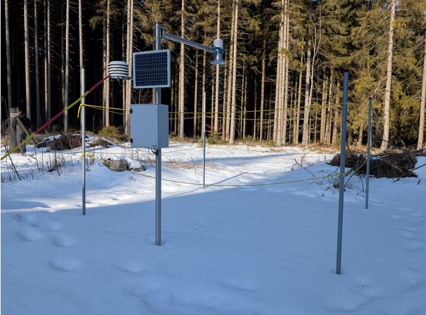
Automatická sněhoměrná stanice s měřením výšky sněhové pokrývky a vodní hodnoty v lokalitě Hubertka (Jeseníky), leden 2026, foto: V. Šustková
