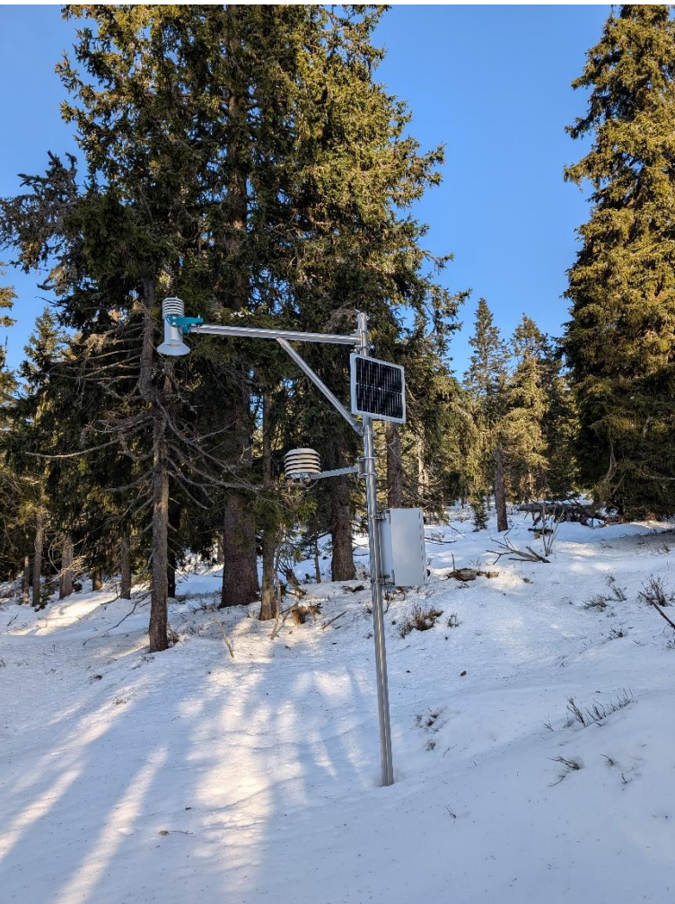
Automatická sněhoměrná stanice s měřením výšky sněhové pokrývky v lokalitě Jelení studánka (vlevo) a Malý Děd (vpravo) v Jeseníkách, leden 2026 (Jelení studánka) a únor 2025 (Malý Děd), foto: V. Šustková
